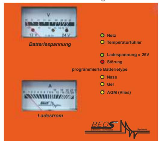
optische Funktionsanzeige, auf welchen Batterietyp das Ladegerät eingestellt ist
